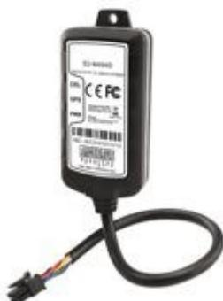
Der **kompakte Camping-Tracker** mit integrierten GSM-Antennen, im wasserdichten IP67-Gehäuse und **Bordnetzanschluss**, wird an Plus (KL30), Minus (KL31) und an die Zündung (KL15) im Wohnmobil oder Wohnwagen angeschlossen. Die GPS Ortung erfolgt in Echtzeit bei **Zündung EIN** und bei **Bewegung**.
